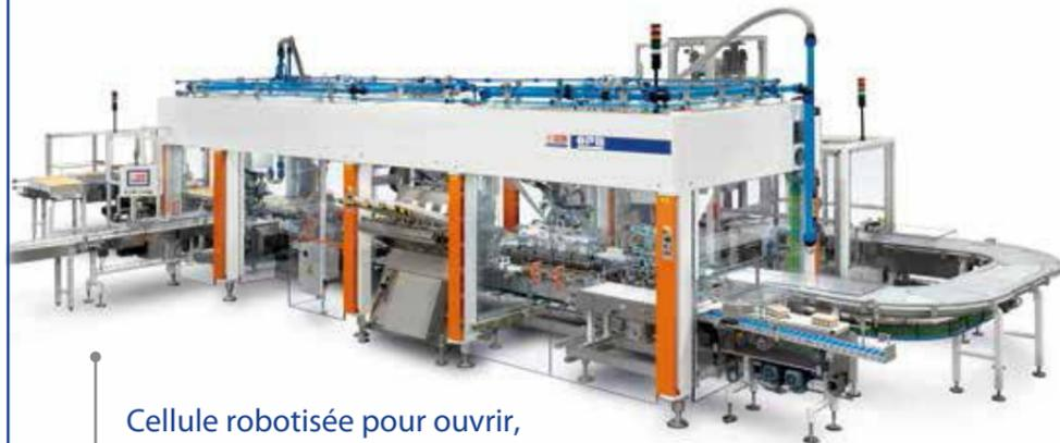
Cellule robotisée pour ouvrir, remplir et fermer des boîtes de pralines déjà enveloppées. La cellule est équipée d'une unité d'insertion d'une feuille sur le fond de la boîte et d'une autre pour l'insertion d'un plateau en plastique entre les deux couches de pralines. La cellule est également équipée d'une série de capteurs permettant de vérifier la configuration correcte des différentes opérations de remplissage de la boîte.
