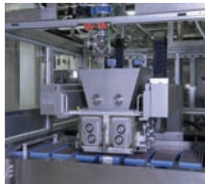
MLR Mouleuse rotative pour dosage par "points", "en ligne" & OneShot par points" et "OneShot en ligne"
