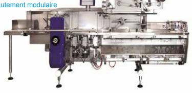
Tous les groupes individuels en mouvement contrôlés par servomoteurs synchronisés pour garantir un maximum de précision, une plus grande flexibilité et simplifier la conception mécanique.
