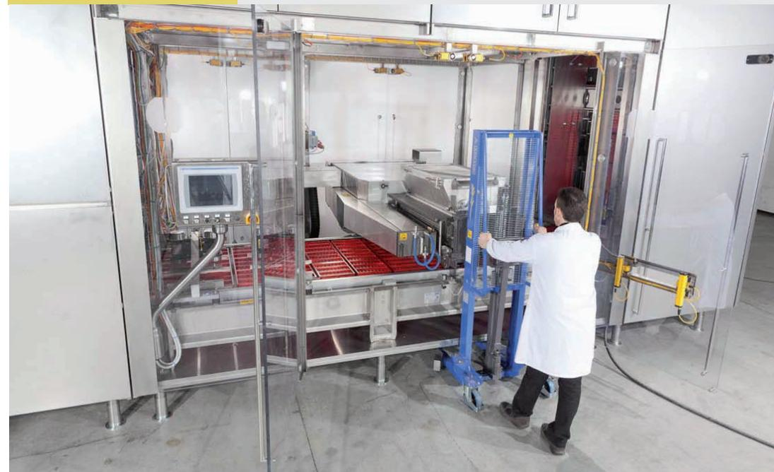
Conçu pour le remplacement sans outil du groupe CORE (bloc piston, trémie, plaque de dosage et mini-palette) pour un changement de production en moins de 10 min
